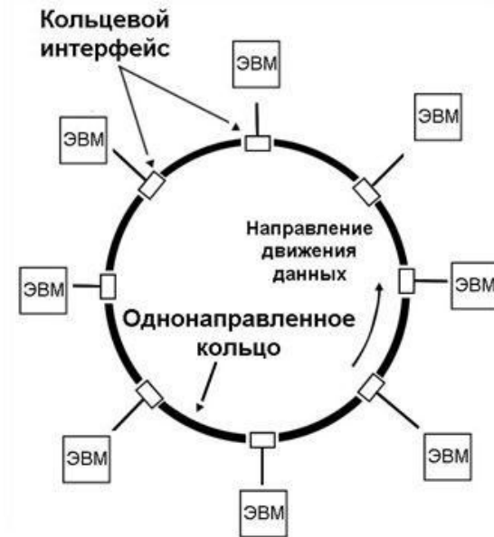
Принцип работы маркерного кольца
