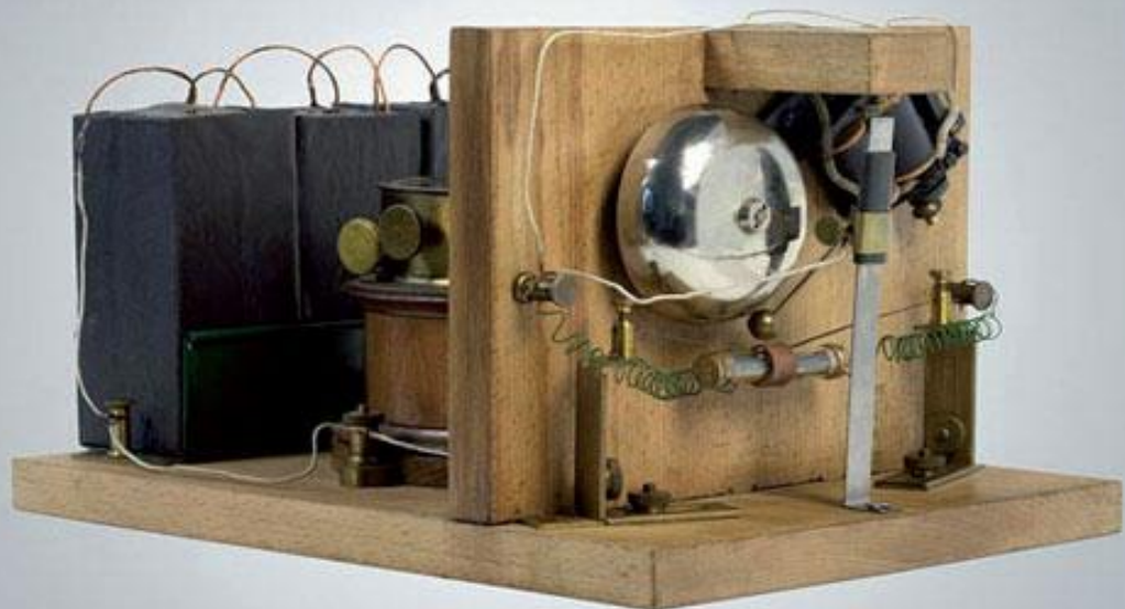
Приемная установка А.С. Попова 1895 г.
