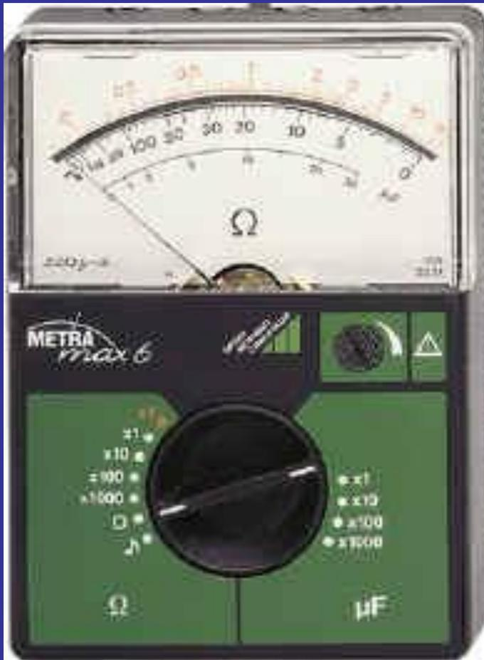
**Оммётр** – измерительный прибор для определения электрических сопротивлений.
