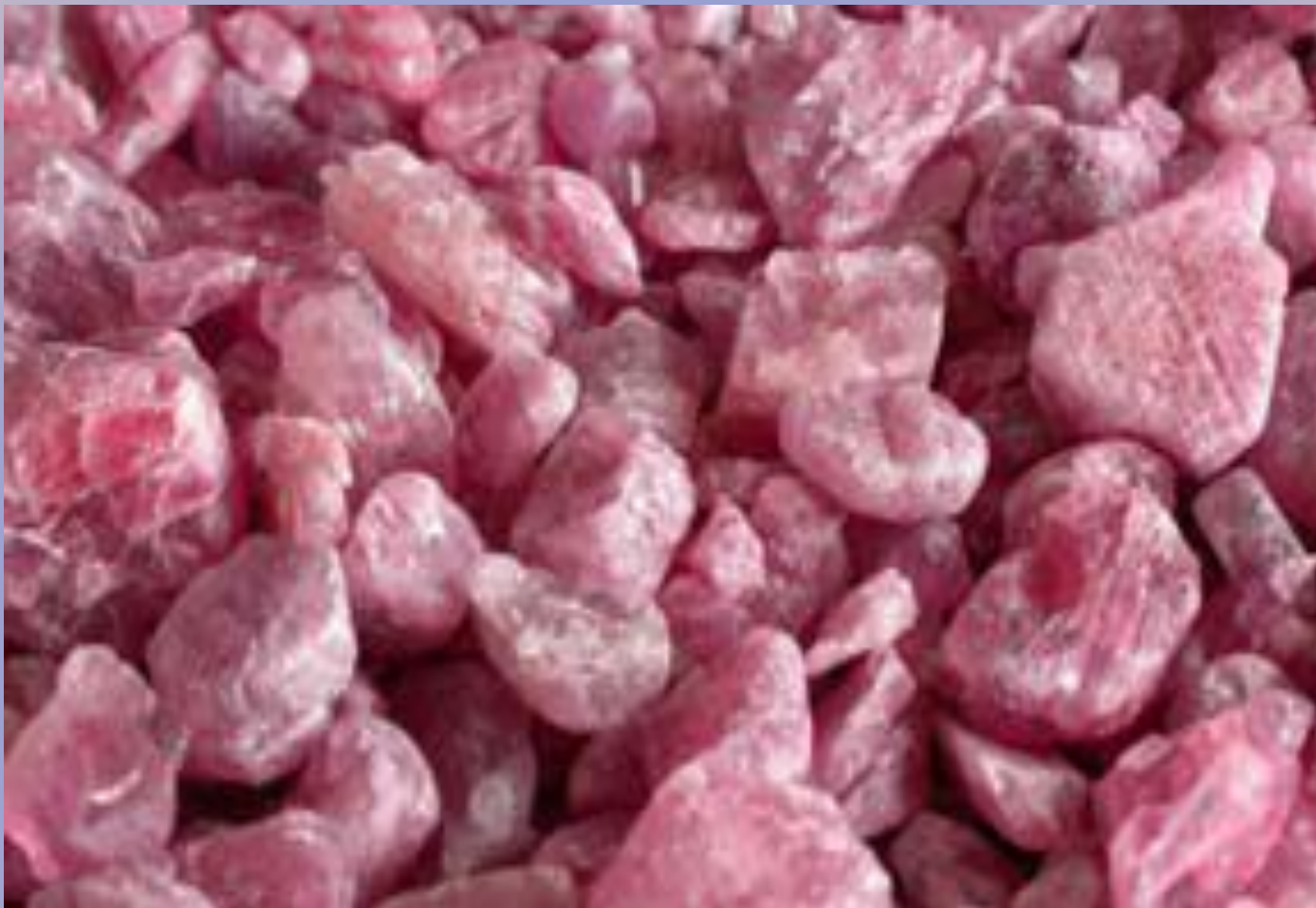
Рис. № 51. Материал после чистки кислотой и предварительной термической обработки, проводящейся без применения добавок, для того, чтобы трещины очистились и можно было проводить обработку свинцовым стеклом.
