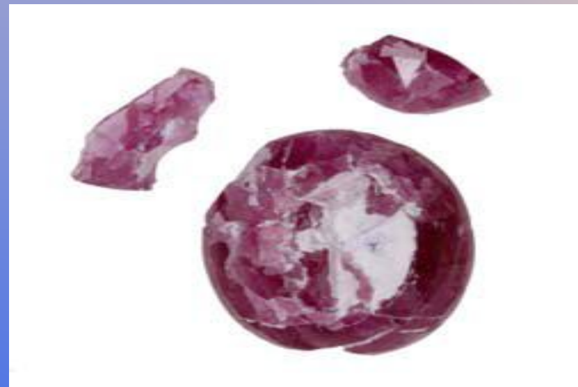
Рис. № 65. Распавшийся на куски корундово-стеклянный материал после воздействия плавиковой кислоты.
