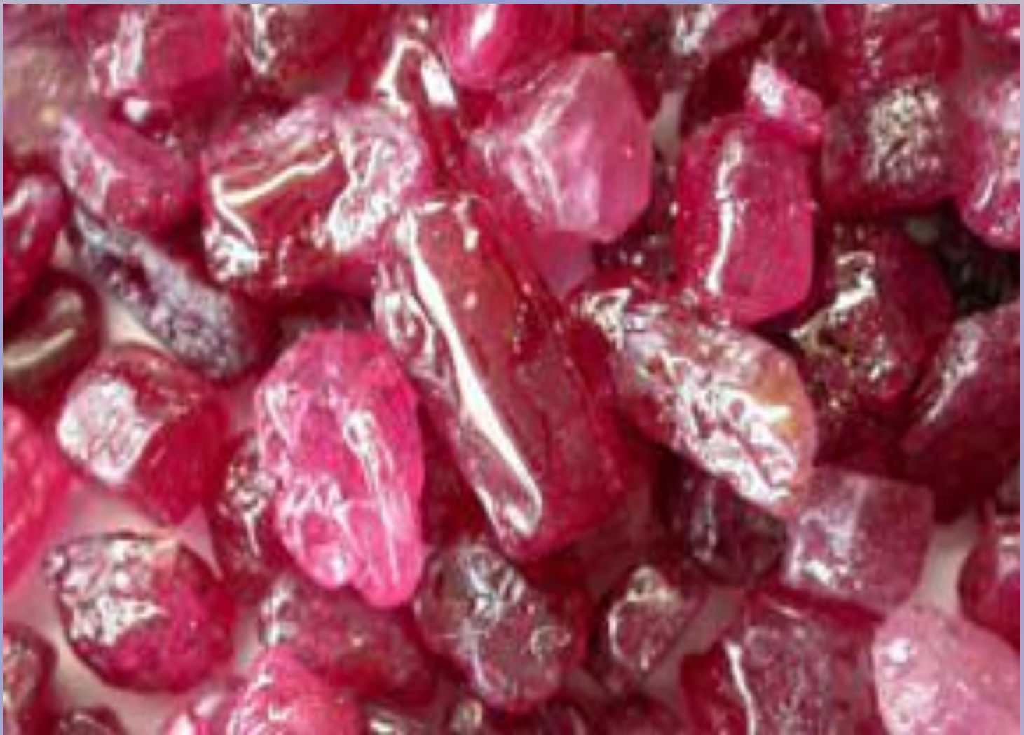
Рис. № 52. Материал после окончательной термической обработки со свинцовым стеклом.
