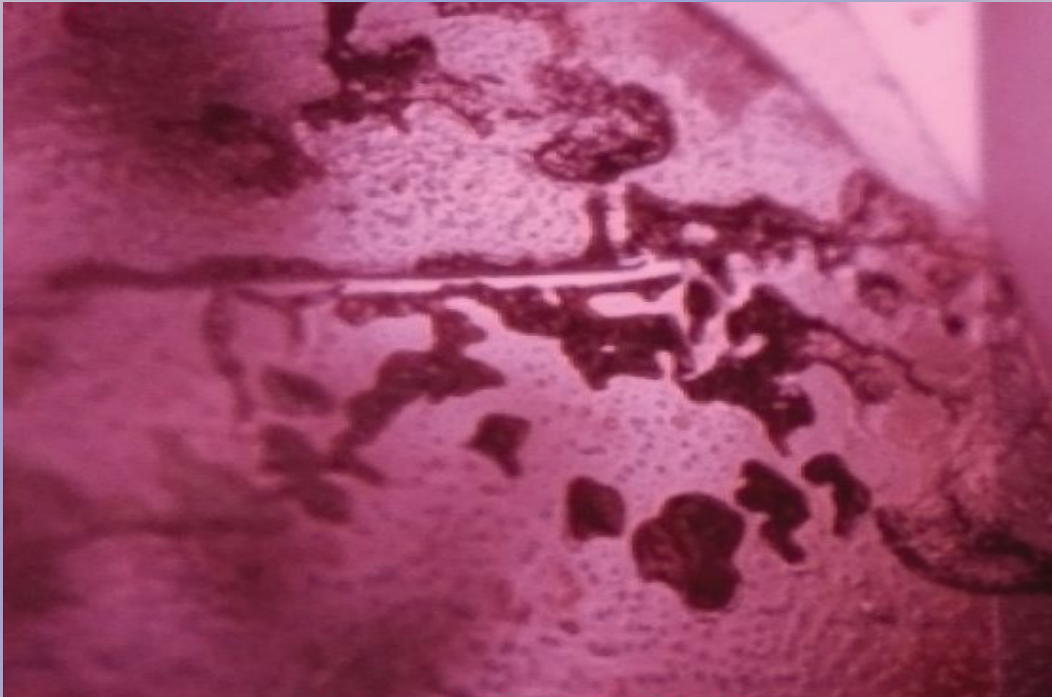
Рис. № 56. Заполненная стеклом трещина с многочисленными газовыми пузырями.
