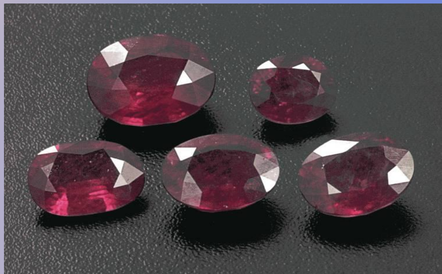
Рис. № 48. Ограненные вставки и бусы из рубина, облагороженного свинцовым стеклом.
