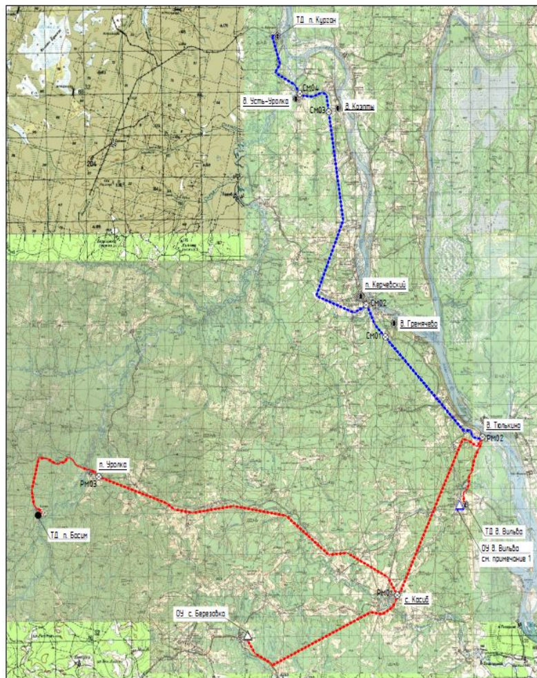
Ситуационная карта-схема ВОЛС в Соликамском и Чердынском районе Пермского края в целях устранения цифрового неравенства М 1:200000
