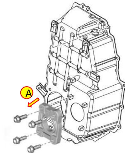
5. Снять кронштейн насоса высокого давления (А).
