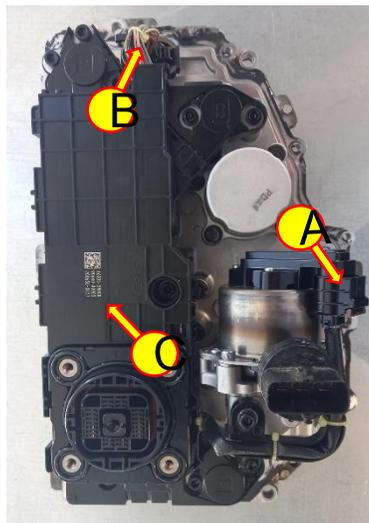
7. Снять разъемы (A) и (B), открутить крепёжные болты и аккуратно снять модуль коммутации (C) (требуется приложение небольшого усилия в районе расположения соленоидов).
