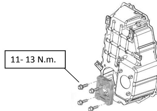
5. Установить демонтированные компоненты и залить жидкость в контур управления DCT в соответствии с TSB HSE21-50-P032-TM PE.
