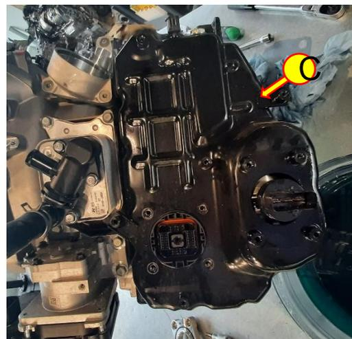
6. Открутить болты (В) крепления разъёма ТСМ, затем открутить крепёжные болты и демонтировать крышку гидроблока (С).
