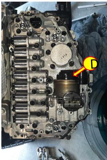
8. Открутить четыре крепежных болта, снять насос высокого давления (D) аккуратно потянув на себя.
