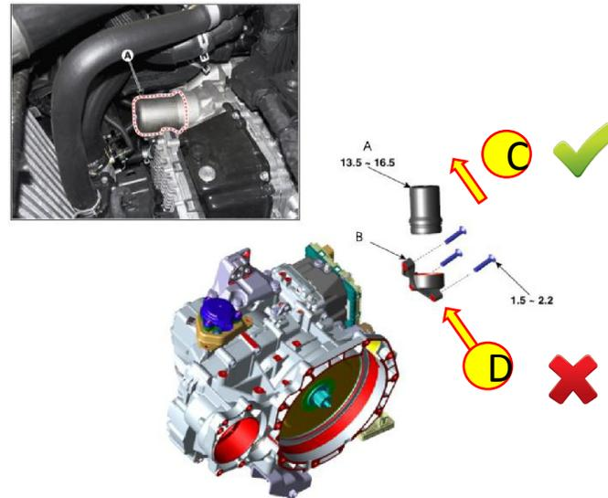
2. Снять гидроаккумулятор (C) без демонтажа адаптера (D) используя технологию предоставленную в TSB HSE21-50-P032-TM PE п.3-3.
