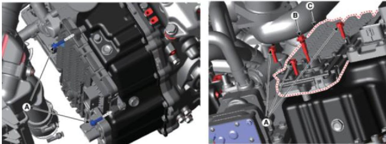
4. Снять блок управления трансмиссией используя технологию предоставленную в TSB HSE21-50-P032-TM PE, п.7-3.
