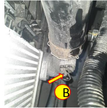
1. Открутить крепеж короба проводки (A) и переместить короб в сторону для освобождения доступа к агрегату, снять патрубок интеркулера (B).
