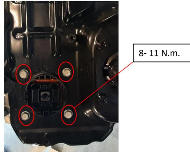
3. Нанести герметик на предварительно очищенные сопрягаемые поверхности и установить крышку гидроблока.
