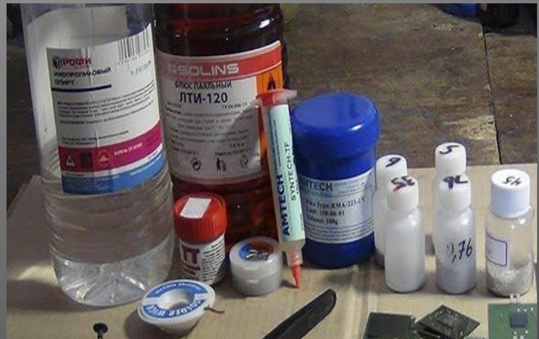
**Припой**—металл или сплав, применяемый при пайке для соединения заготовок и имеющий температуру плавления ниже, чем соединяемые металлы. Применяют сплавы на основе олова, свинца, кадмия, меди.
