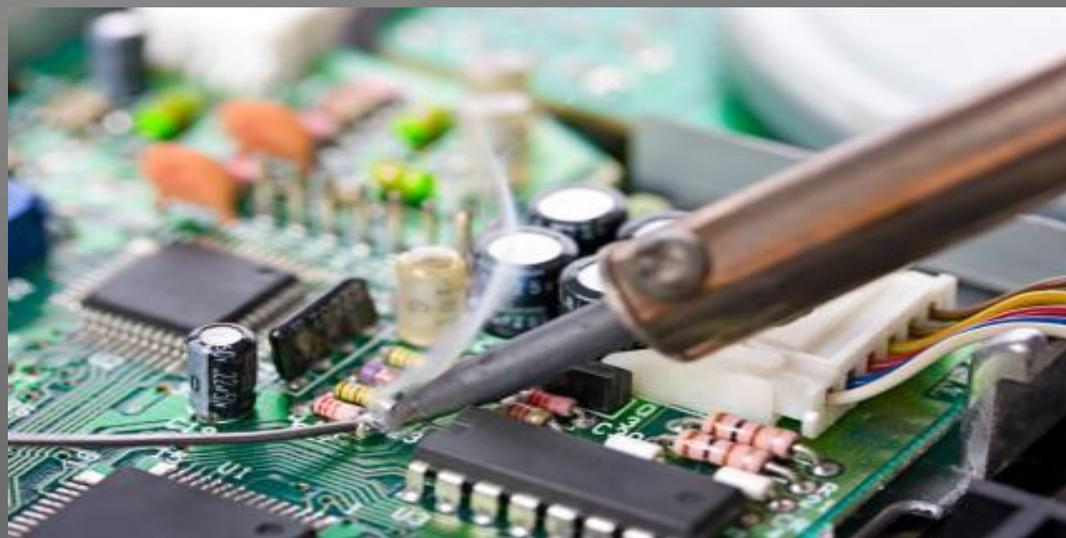
**Флюс**— вещества (чаще смесь) органического и неорганического происхождения, предназначенные для удаления оксидов с поверхности под пайку, снижения поверхностного натяжения, улучшения растекания жидкого припоя и/или защиты нагретого металл от окисления и окружающей среды.
