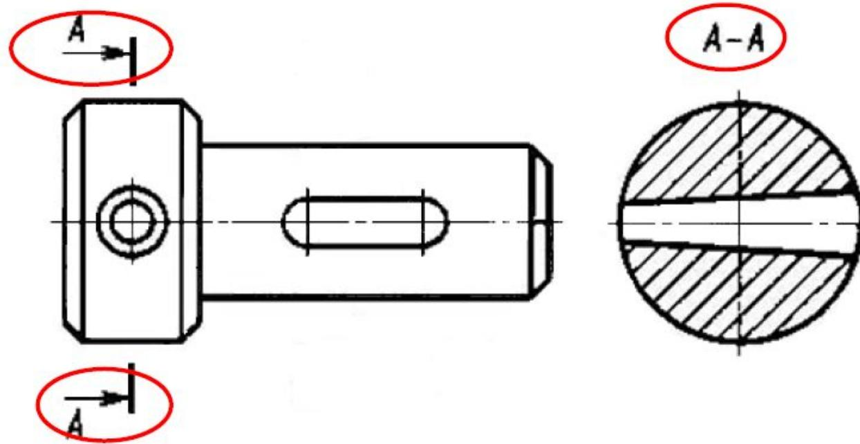
*На чертеже, выполненном в проекционной связи, обозначается секущая плоскость (A-A).*
