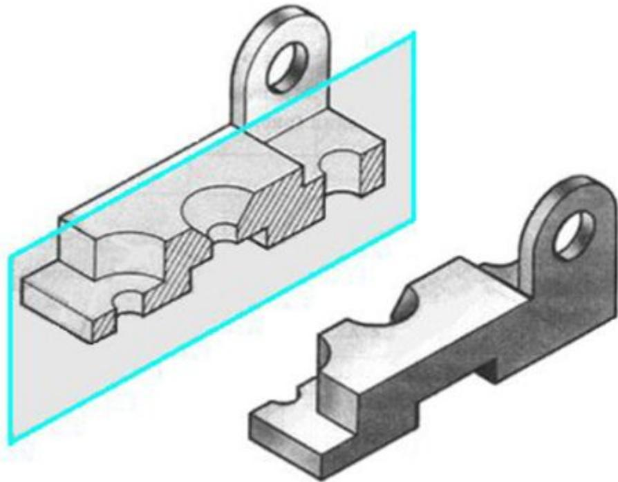
*а) Простые — при одной секущей плоскости;*
