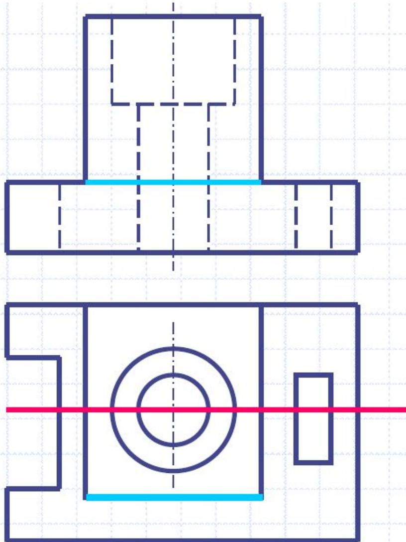
6. Удаление линий видимого контура, относящегося к удаленной части;
