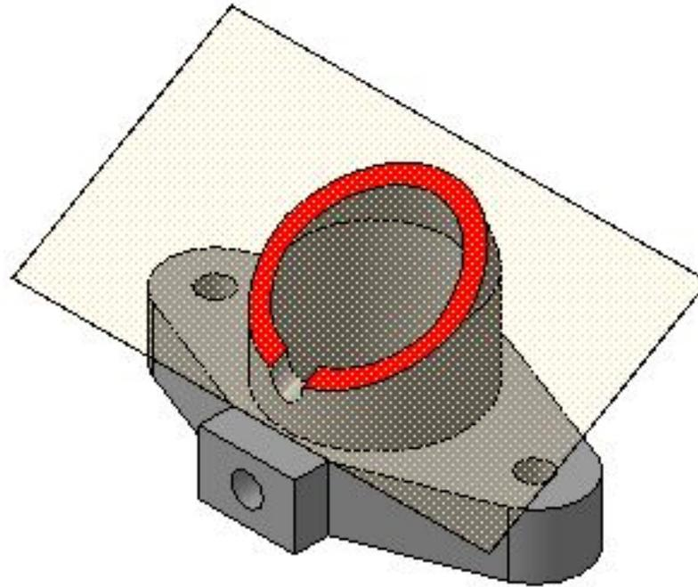
*Наклонные разрезы* – секущая плоскость наклонена к плоскости проекций, секущая плоскость составляет с горизонтальной плоскостью проекций угол, отличный от прямого.
