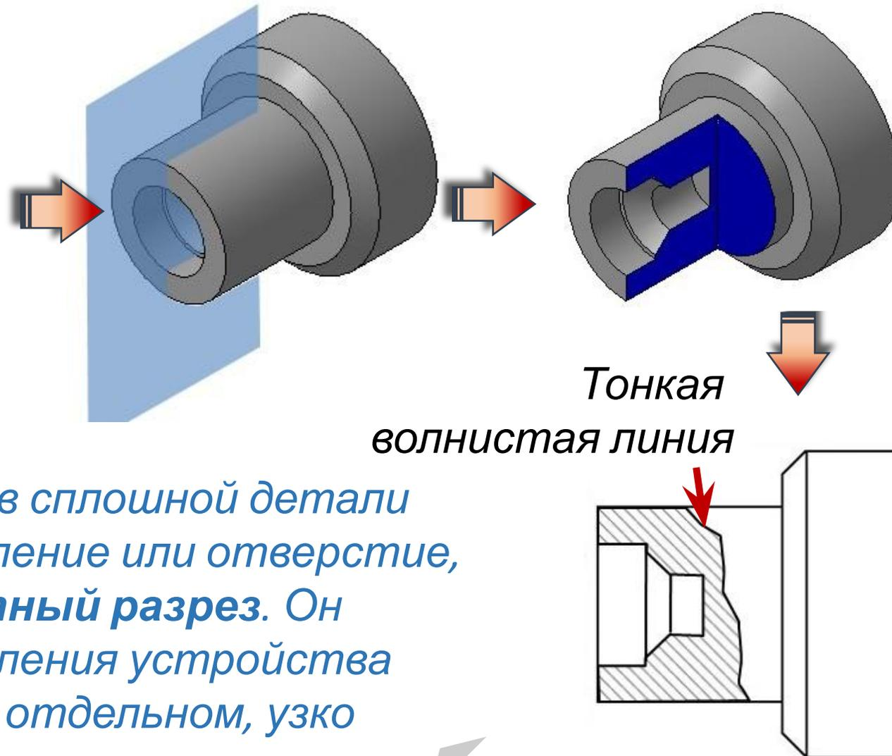
*Чтобы показать в сплошной детали небольшое углубление или отверстие, применяют **местный разрез**. Он служит для выявления устройства предмета лишь в отдельном, узко ограниченном месте.*
