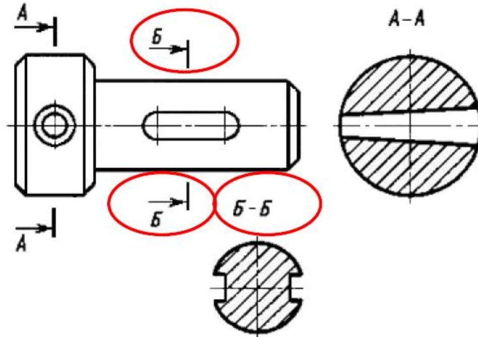
*При выполнении сечения на свободном месте чертежа обозначается плоскость – пример: (Б-Б).*
