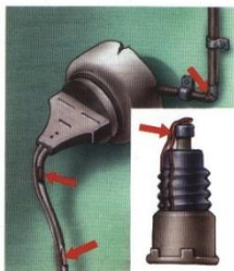
Несправность электропроводки Пользование самодельными предохранителями
