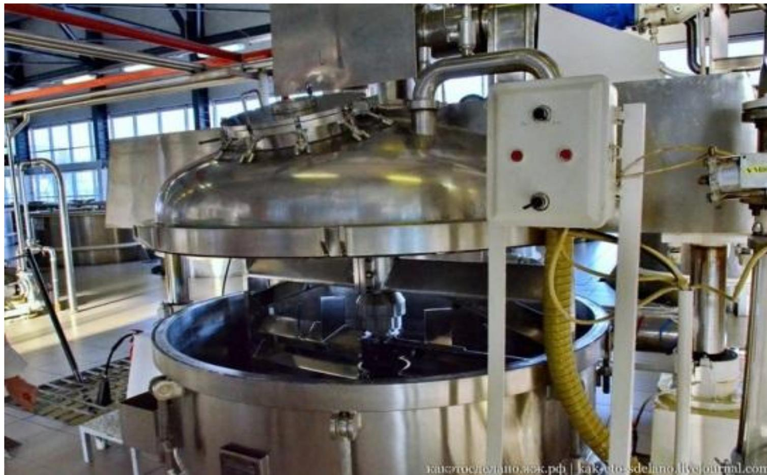
ВНУТРИ НАХОДЯТСЯ ЛОПАСТИ ДЛЯ ТОГО, ЧТОБЫ ТЩАТЕЛЬНОЕ СМЕШИВАТЬ ВОДУ И ПРОЧИЕ ИНГРЕДИЕНТЫ. ЛОПАСТИ ВРАЩАЮТСЯ СО СКОРОСТЬЮ 24-25 ОБОРОТОВ В МИНУТУ. КРОМЕ ТОГО, ЗДЕСЬ ЕЩЕ ЕСТЬ ЯКОРНАЯ МЕШАЛКА И ТУРБИНАЯ МЕШАЛКА КОТОРАЯ ДАЕТ 990 - 1000 ОБОРОТОВ В МИНУТУ.
