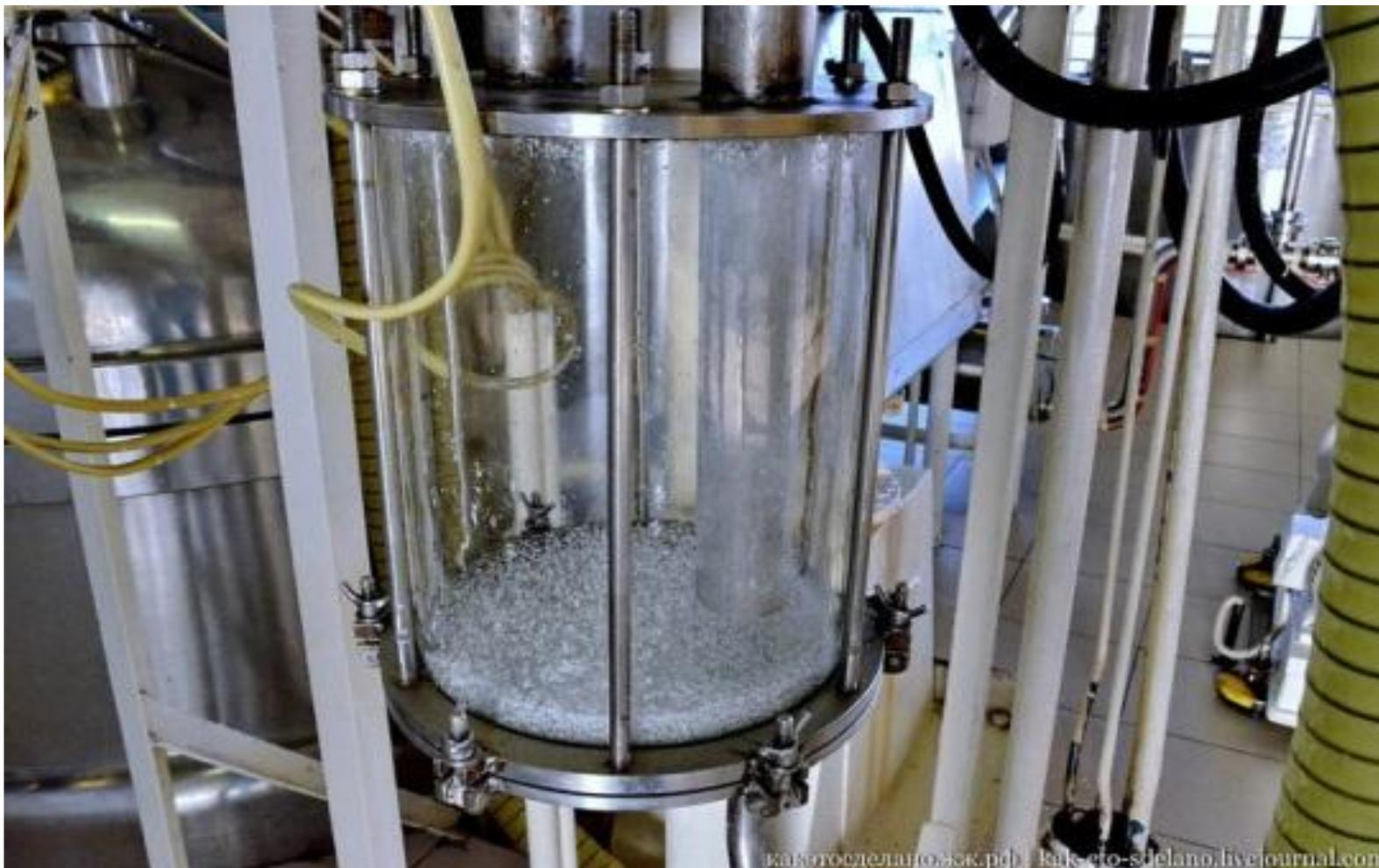
В РЕАКТОРЕ ВАРИТСЯ ДО 3 ТОНН ПАСТЫ. ОДНОВРЕМЕННО МОЖЕТ РАБОТАТЬ ОДИН ИЛИ НЕСКОЛЬКО АППАРАТОВ, В ЗАВИСИМОСТИ ОТ ПОТРЕБНОСТЕЙ ФАБРИКИ. ДЛЯ ОБСЛУЖИВАНИЯ ВСЕХ 5 РЕАКТОРОВ ДОСТАТОЧНО ВСЕГО ТРЕХ ЧЕЛОВЕК ПОСЛЕ ТОГО, КАК ПАСТА ГОТОВА, БЕРУТ ПРОБУ НА АНАЛИЗ НА СООТВЕТСТВИЕ ГОСТУ ПО ФИЗИКО-ХИМИЧЕСКИМ ПОКАЗАТЕЛЯМ И МИКРОБИОЛОГИИ, ЗАТЕМ МАССУ ПЕРЕКАЧИВАЮТ В ЕМКОСТИ ДЛЯ ХРАНЕНИЯ ГОТОВОЙ ЗУБНОЙ ПАСТЫ.
