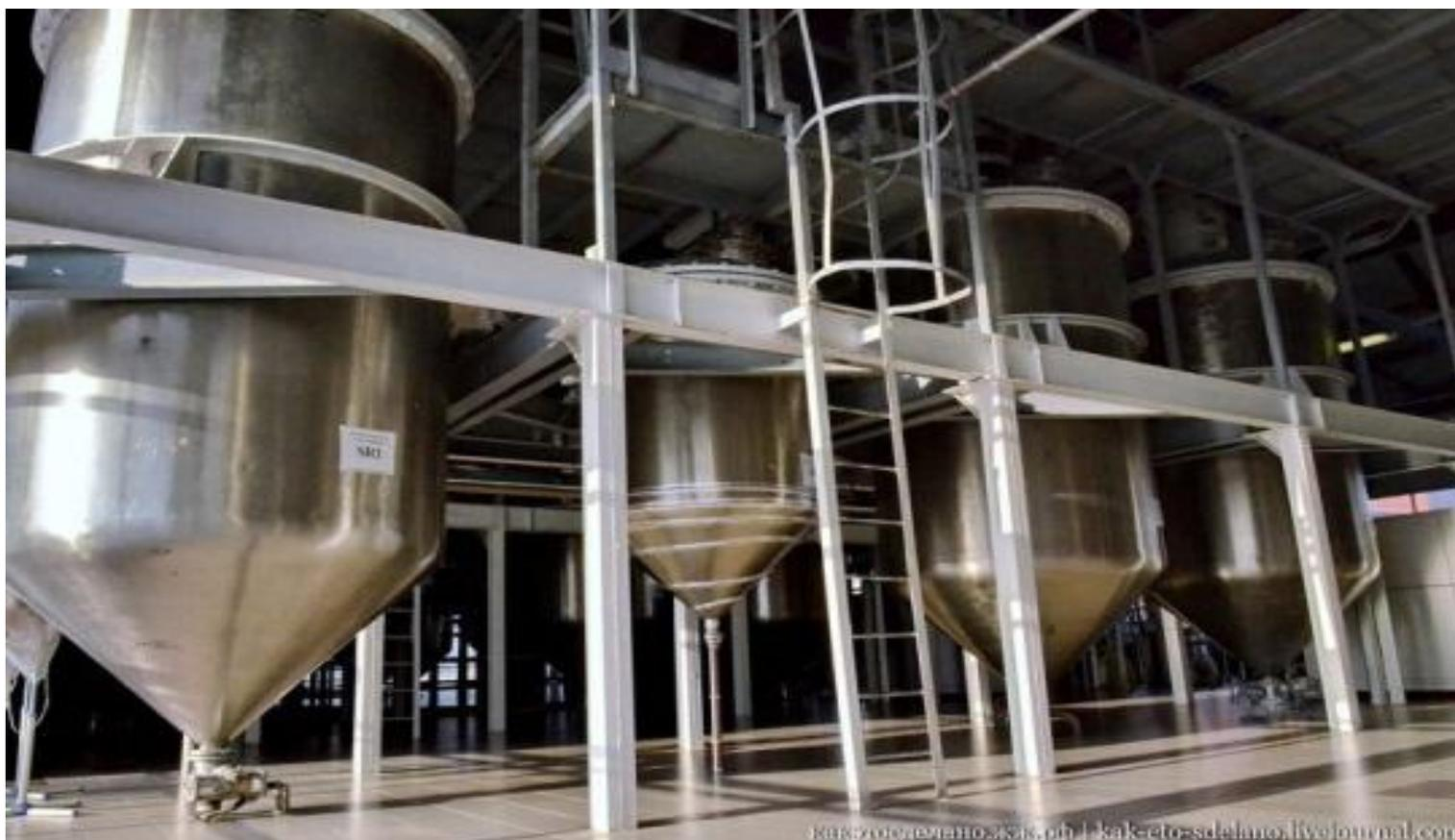
ИЗ ЭТИХ ЕМКОВ И ИНГРЕДИЕНТЫ ПОСТУПАЮТ В РЕАКТОР, ГДЕ ОНИ В ВАКУУМЕ, ПРИ ТЕМПЕРАТУРЕ НИЖЕ ТЕМПЕРАТУРЫ ЧЕЛОВЕЧЕСКОГО ТЕЛА ТЩАТЕЛЬНО РАЗМЕШИВАЮТСЯ В ОДНОРОДНУЮ МАССУ.
