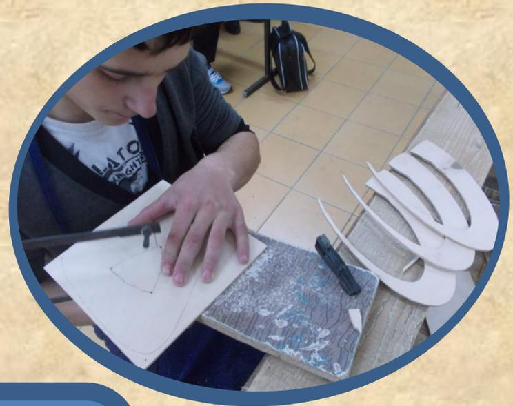
Для изготовления детали атома необходимо: *рисунок, заготовки, карандаш, линейка, кнопки, выпилочный столик и ручной лобзик.*
