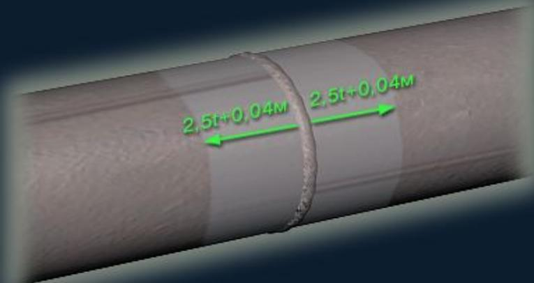
Зона контроля дефектного сварного шва
