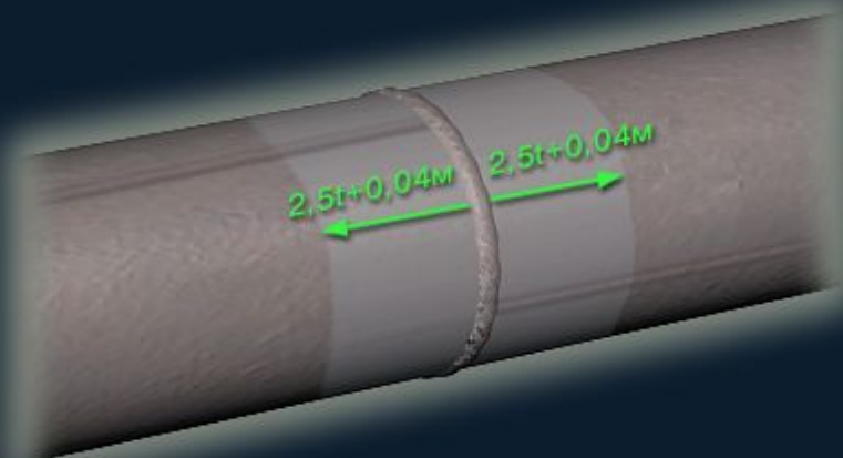
Зона контроля дефектного сварного шва
