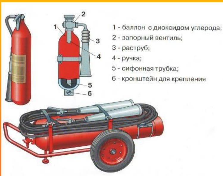
Используют при загораниях на электроустановках под напряжением до 1000 В, при пожарах в музеях, архивах
