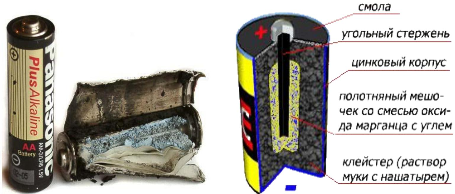
**Гальванический элемент** – химический источник тока, в котором электрическая энергия вырабатывается в результате прямого преобразования химической энергии окислительно-восстановительной реакцией.
