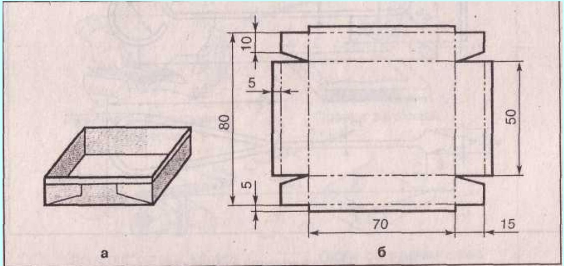
Рис. 52. Объемное изделие из тонколистового металла:
