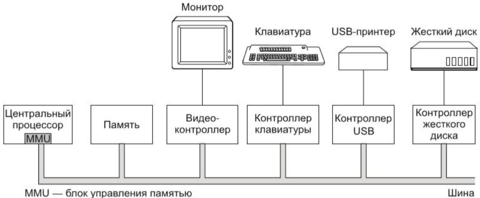
Центральный процессор, память и устройства ввода-вывода соединены системной шиной, по которой они обмениваются информацией друг с другом. Современные персональные компьютеры имеют более сложную структуру и используют несколько шин.
