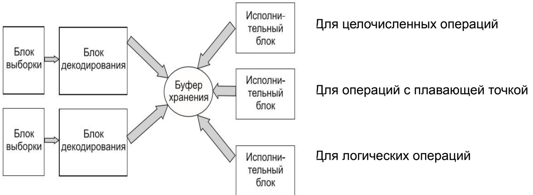
За один такт считываются две или более команды, которые помещаются в буфер хранения, где ожидают обработки на соответствующем процессоре.
