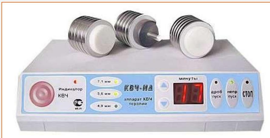
Лечебное воздействие осуществляется электромагнитными волнами диапазона крайне высоких частот (КВЧ). Аппарат КВЧ-НД генерирует три наиболее часто используемые в медицинской практике длины волны КВЧ-диапазона: 4,9 мм (60,12 ГГц), 5,6 мм (53,53 ГГц) и 7,1 мм (42,19 ГГц).
