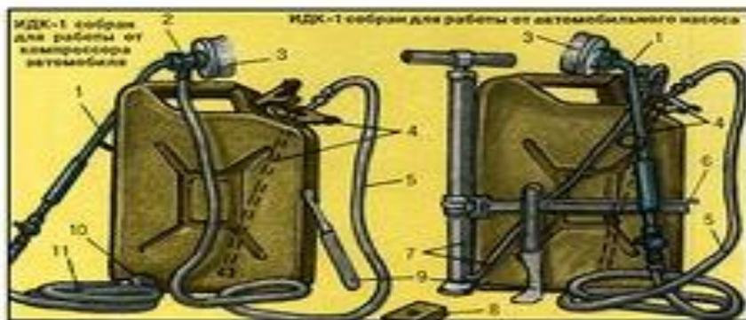
1. Брандспойт. 2. Эжекторная насадка. 3. Щётка. 4. Специальная крышка с рукавом и фильтром. 5. Рукав для подвода раствора из ёмкости. 6. Хомут. 7. Насос с шлангом. 8. Комплект ЗИП. 9. Скребок. 10. Переходник. 11. Рукав для подвода сжатого воздуха.
