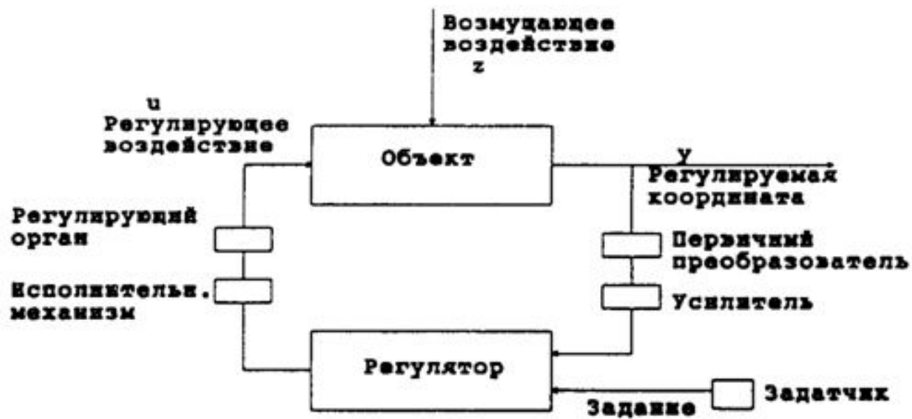
Рис.5. Структурная схема системы автоматического регулирования
