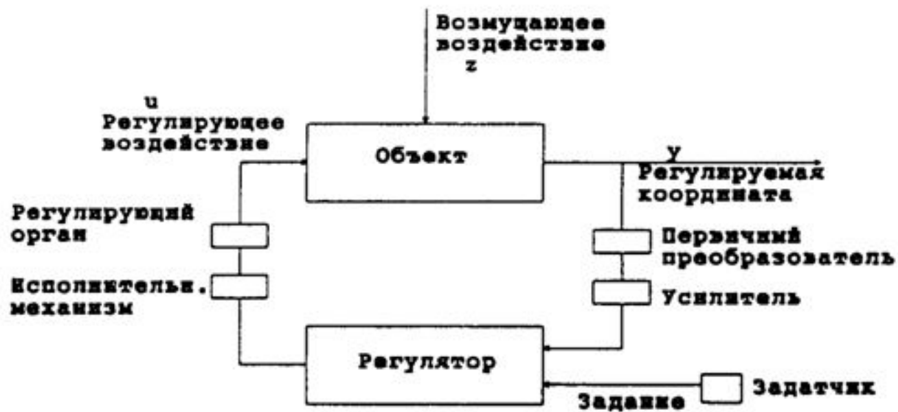
Рис.5. Структурная схема системы автоматического регулирования
