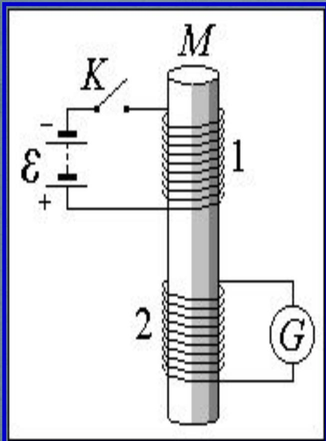
«На широкую деревянную катушку была намотана медная проволока длиной в 203 фута и между витками её намотана проволока такой же длины, изолированная от первой хлопчатобумажной нитью.
