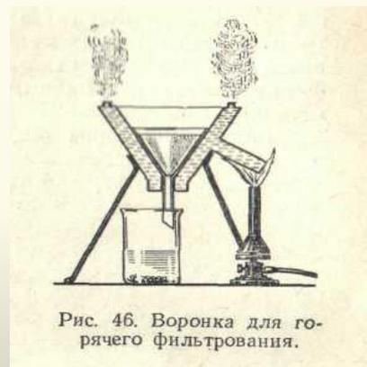
Рис. 46. Воронка для горячего фильтрования.
