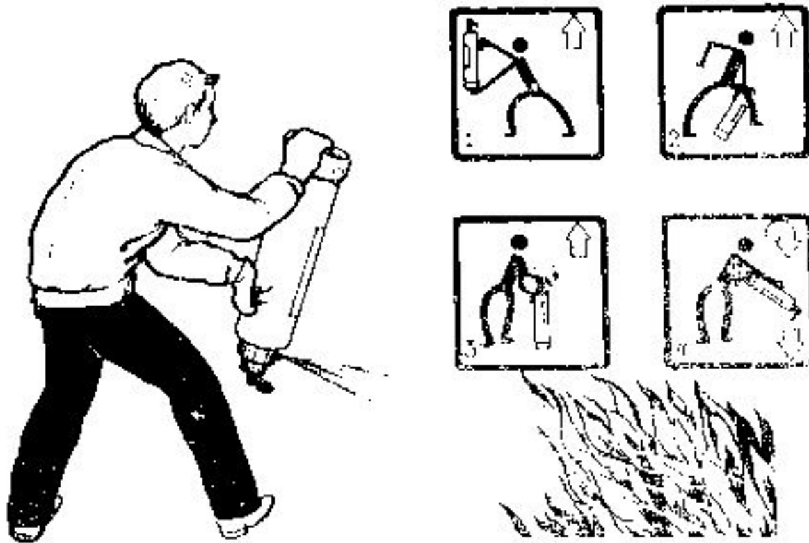
Рис. 53 Действия с огнетушителем химическим пенным
