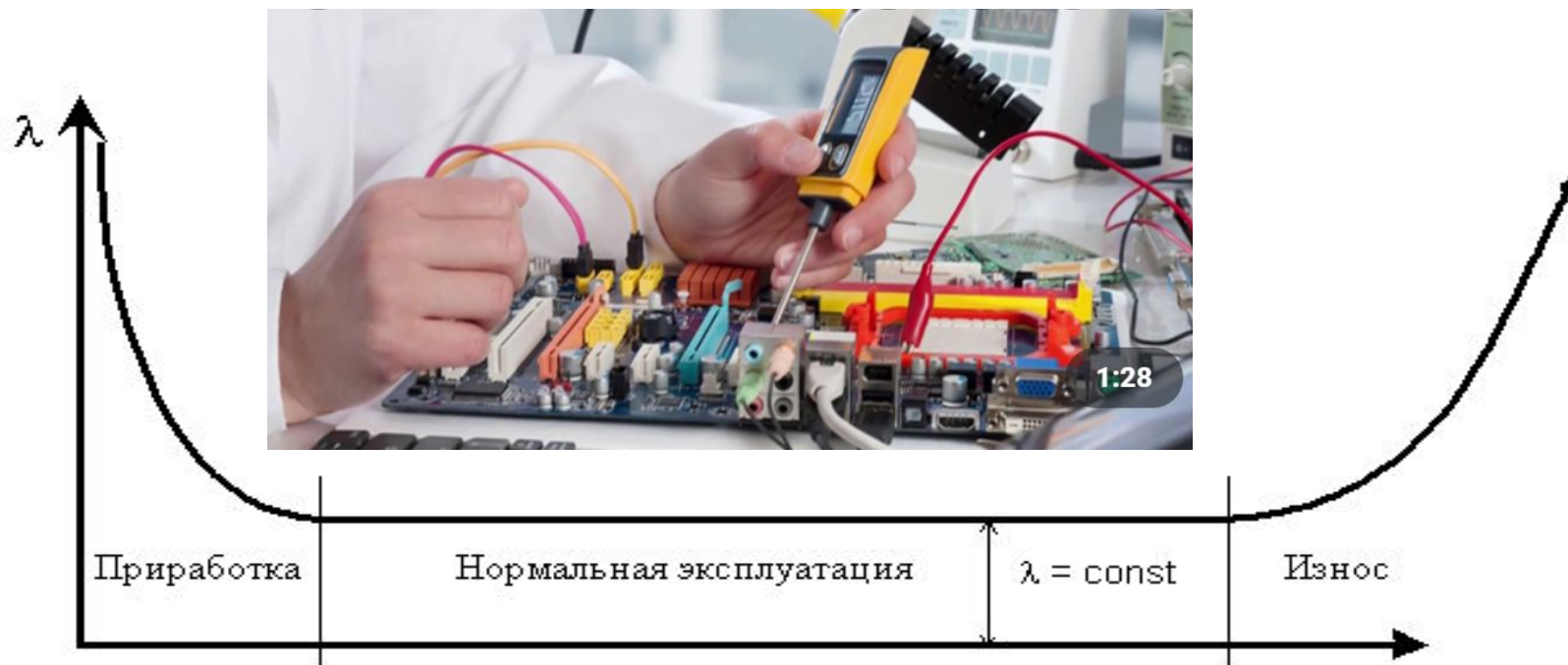
Рис. 3.1. Зависимость интенсивности отказов от времени
