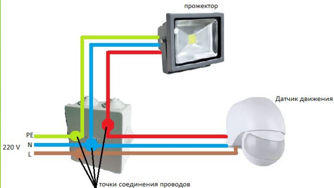
Схема подключения светодиодного прожектора к датчику движения
