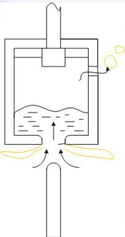
Происходит удаление из камеры оставшихся после гашения дуги горячих газов, продуктов разложения масла и заполнение внутренней полости камеры свежим маслом. На этом этапе происходит подготовка камеры для последующего ее включения и нового отключения.
