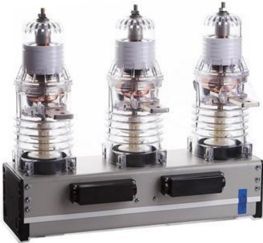
Электрическая прочность вакуума значительно выше других сред, применяемых в выключателях. Объясняется это увеличением длины среднего свободного пробега электронов, атомов, ионов и молекул по мере уменьшения давления. Процесс восстановления электрической прочности промежутка между контактами при отключении тока протекает в вакууме значительно быстрее, чем в газах.
