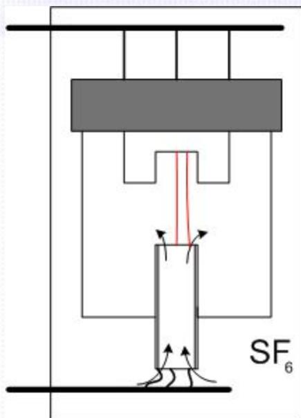
При размыкании главных контактов ток проходит по цепи дугогасительных контактов .
