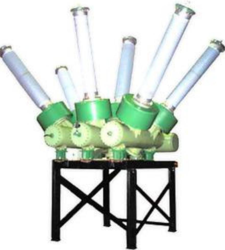
В элегазовых выключателях дугогасящей средой является элегаз. Элегаз ( $\text{SF}_6$  – шестифтористая сера) представляет собой инертный газ, плотность которого превышает плотность воздуха в 5 раз. Электрическая прочность элегаза в 2 – 3 раза выше прочности воздуха; при давлении 0,2 МПа электрическая прочность элегаза сравнима с прочностью масла. В элегазе при атмосферном давлении может быть погашена дуга с током, который в 100 раз превышает ток, отключаемый в воздухе при тех же условиях.
