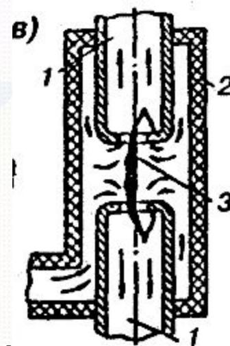
При отключении выключателя (см. рис. а) под действием сжатого воздуха контакты 1 расходятся на необходимое для гашения дуги 3 расстояние и одновременно возникает интенсивное дутье. Поток воздуха внутри трубчатых изоляторов удаляет из дугового промежутка продукты горения дуги, представляющие собой хорошо проводящую среду. Их место занимает свежий неионизированный воздух, обладающий высокой электрической прочностью. При прохождении тока через нуль дуга гаснет.
