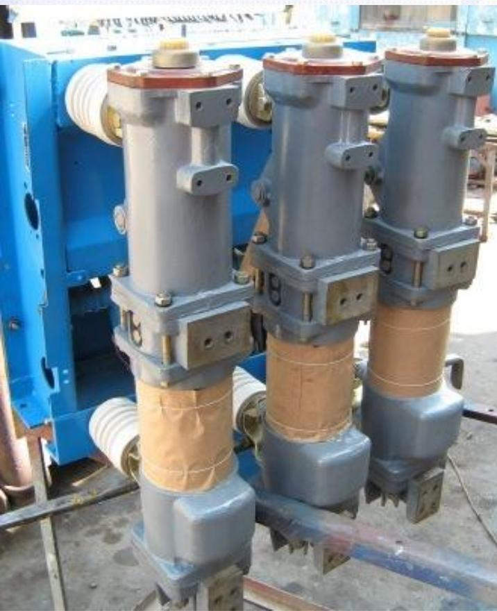
В маломасляных выключателях масло служит только в качестве газогенерирующего материала, создающего условия для гашения дуги. Для изоляции токоведущих частей используют фарфор, стеклопластик, текстолит и другие изоляционные материалы. Они используются в электрических сетях 6-220 кВ. Все они оснащены гасительными камерами того или иного исполнения.
