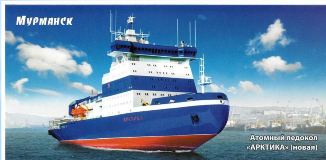
Атомный ледокол «Арктика» - первое в истории судно, совершившее экспедицию на Северный полюс и достигло его в 1977 г.; второй в мире атомный ледокол. Ледоколам данного типа не страшен лед мощностью до 3 м. Спуск на воду был произведен в 1972 г. В 2018 г. корабль был отбуксирован из Мурманска в акваторию завода «Нерпа» — для дальнейшей утилизации.
