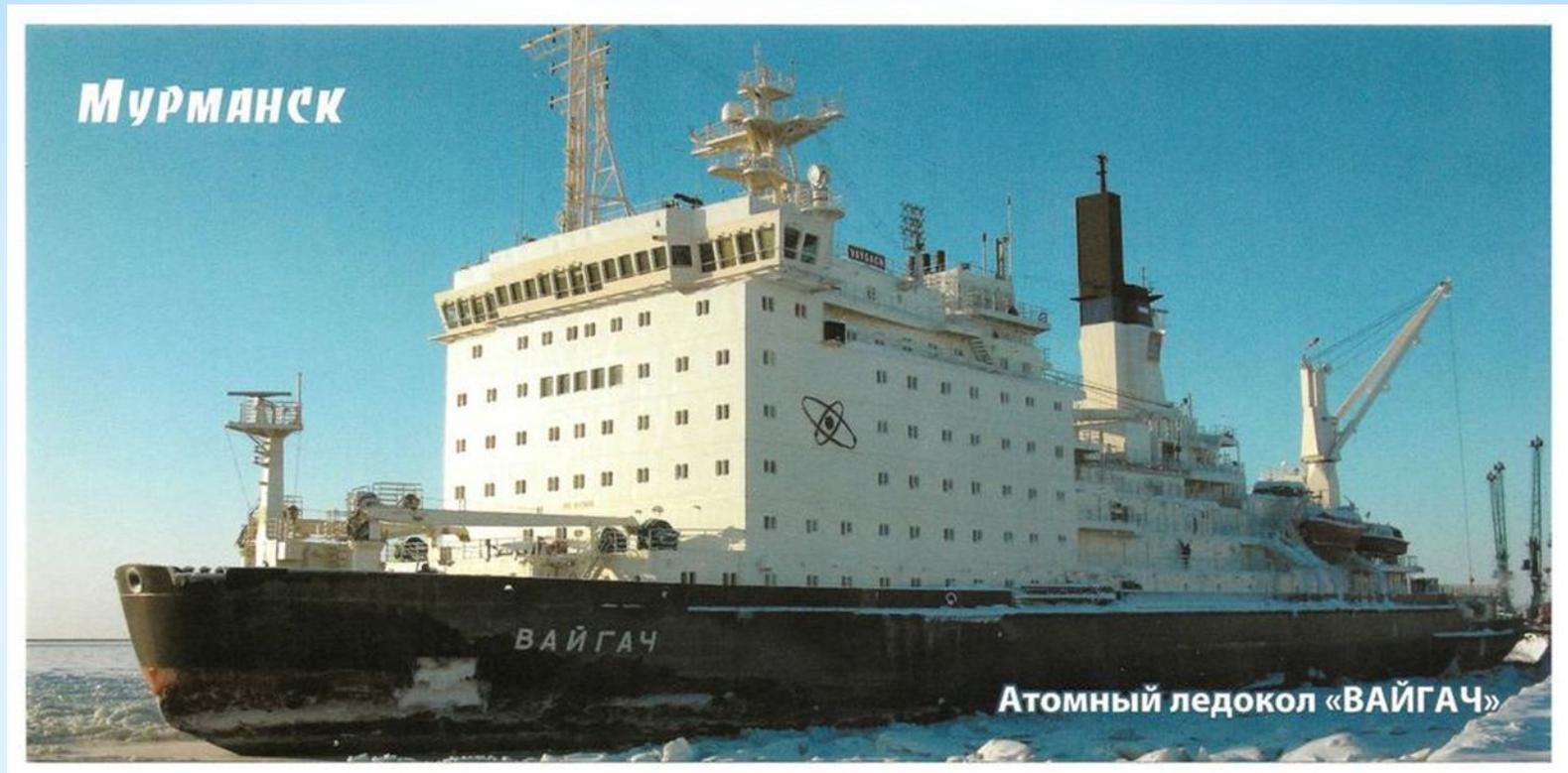
Ледокол "Вайгач" - мелкосидящий атомный ледокол проекта «Таймыр», позволяющий обслуживать суда следующие по Северному Морскому Пути с заходом в устья сибирских рек. Ледокол может действовать при температурах до  $-50^{\circ}\text{C}$ . Основное применение - сопровождение транспортных судов с продукцией комбината Норильский никель из Норильска и судов с лесом и рудой от Игарки до Диксона.
