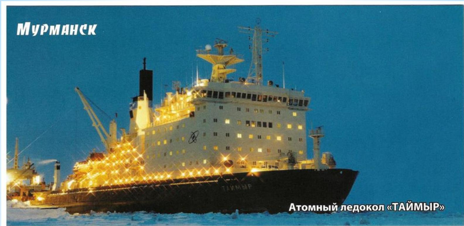
Ледокол «Таймыр» - атомный ледокол, предназначенный для проводки судов в устья сибирских рек. Введен в эксплуатацию в 1989 г. Отличается от остальных уменьшенной осадкой. Атомная установка позволяет ледоколу идти через лёд толщиной в два метра. Ледокол может действовать при температурах до  $-50\text{ }^{\circ}\text{C}$ .
