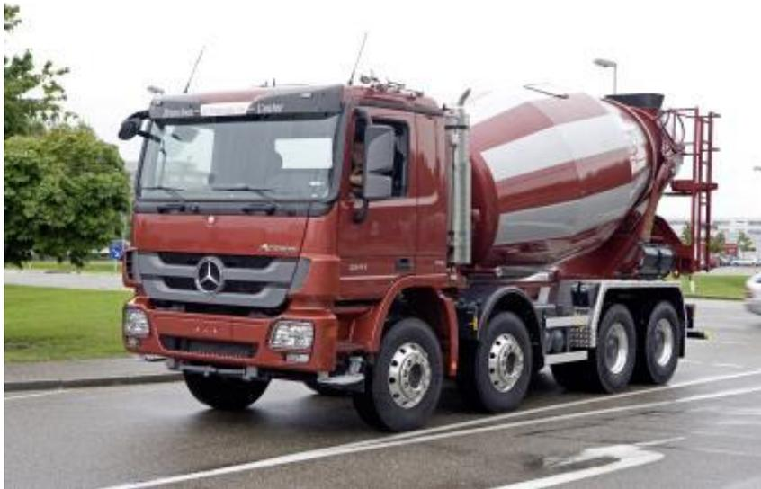
Предназначен для транспортировки бетона в жидком состоянии.
