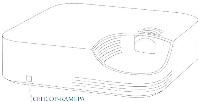
Сенсор-камера, встроенная в проектор, следит за перемещением интерактивного инструмента возле проекции, по беспроводному каналу передает координаты к подключенному компьютеру.
