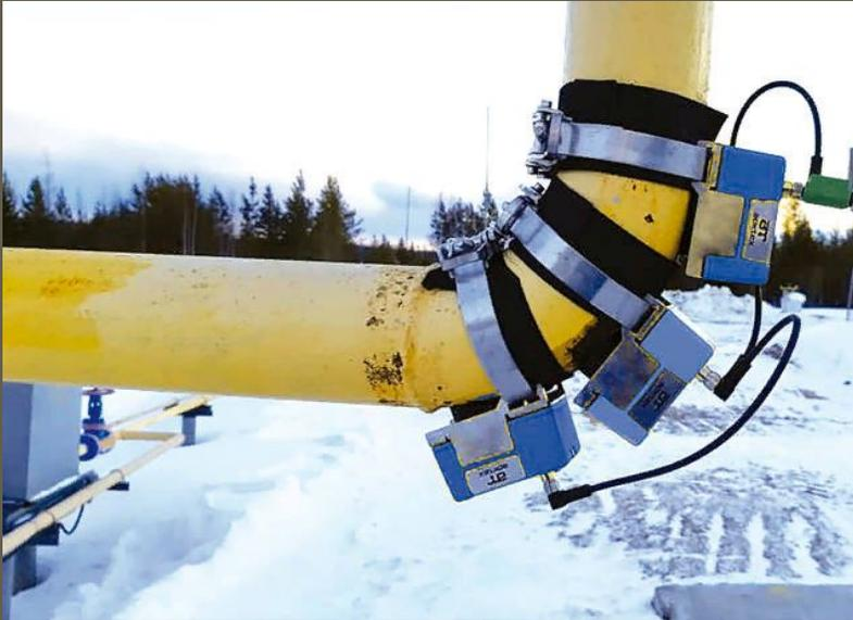
Метод электрического сопротивления схож с гравиметрическим методом, но вместо образца-свидетеля используется чувствительный элемент — ER-датчик. Принцип работы построен на изменении электрического сопротивления на чувствительном элементе зонда.
