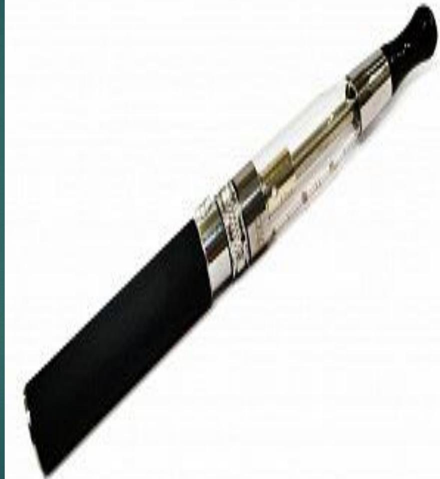
Электронная сигарета состоит из двух основных частей: батареиный блок (блок аккумуляторов, «мод», «мехмод») и испаритель («атомайзер», «картридж», «бак», «дрипка», «дрипкобак», «клиромайзер»). Ток от батарейного блока подаётся на нагревательный элемент в испаритель, что преобразует заправленную жидкость в пар.
