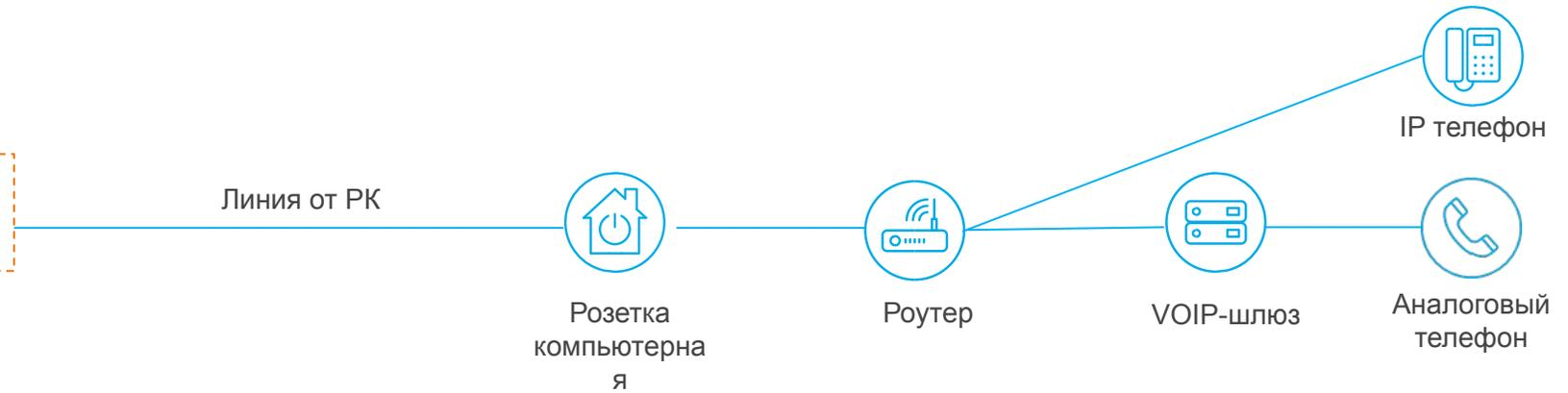
Схема подключения ПО по технологии PON/FTTH
