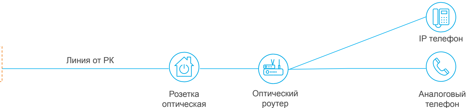
Схема подключения ПО по технологии PON/FTTH
