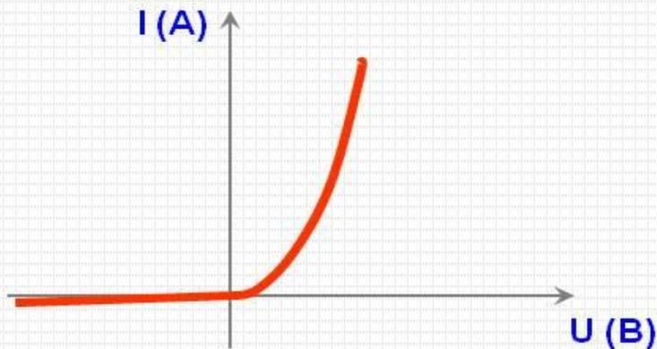
Основное свойство диода – его односторонняя электрическая проводимость
