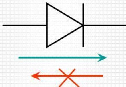
Обозначение полупроводникового диода на схемах
