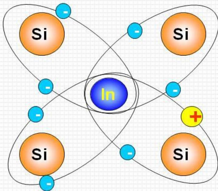
Изменяя концентрацию индия, можно в широких пределах изменять проводимость кремния, создавая полупроводник с заданными электрическими свойствами
