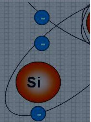
в условиях (невысоких температурах) в полупроводниках отсутствуют свободные заряженные частицы, поэтому полупроводник не проводит электрический ток
