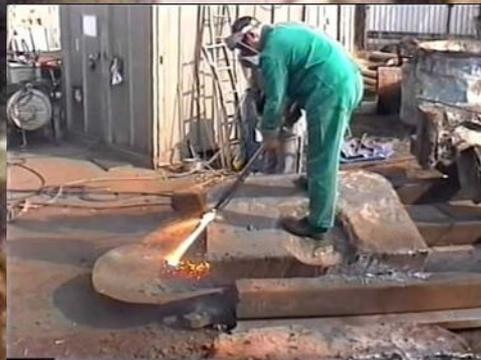
Продукты сгорания флюса образуют с тугоплавкими окислами разрезаемого материала жидкотекучие шлаки, которые удаляются из реза струей режущего кислорода - это химическое действие флюса.
