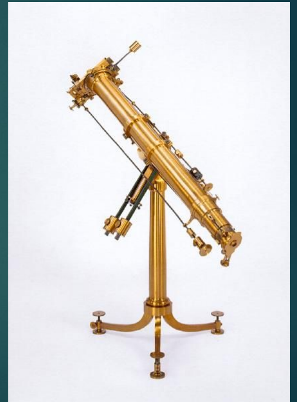
Рис. 8.4. Гелиометр Фраунгофера Королевской обсерватории Кёнигсберга, который был использован для измерения параллакса (расстояния) звезд. В 1838 году Бессель определил, что расстояние до звезды 61 Лебеда примерно в 650 000 раз превышает расстояние до Солнца.
