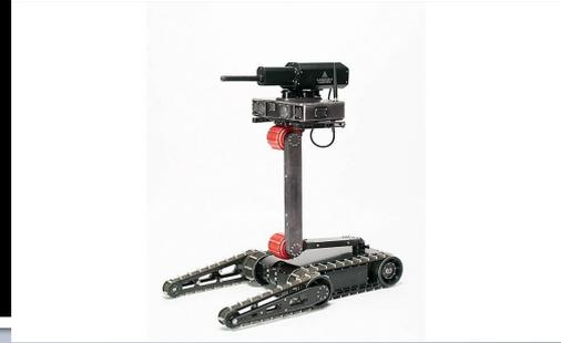
Переносится одним человеком в рюкзаке (вес 13-25 кг в зависимости от конфигурации), Потребитель может сам перед заказом определить вид шасси, вид руки, ее захвата, головы робота
