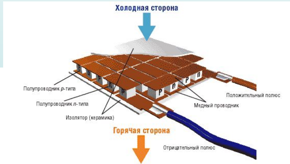
Рис. 19. Конструктивное исполнение полупроводникового термоэлектрического модуля Пельтье
