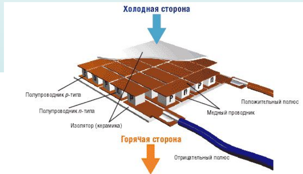
Рис. 19. Конструктивное исполнение полупроводникового термоэлектрического модуля Пельтье
