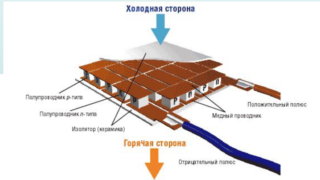
Рис. 19. Конструктивное исполнение полупроводникового термоэлектрического модуля Пельтье
