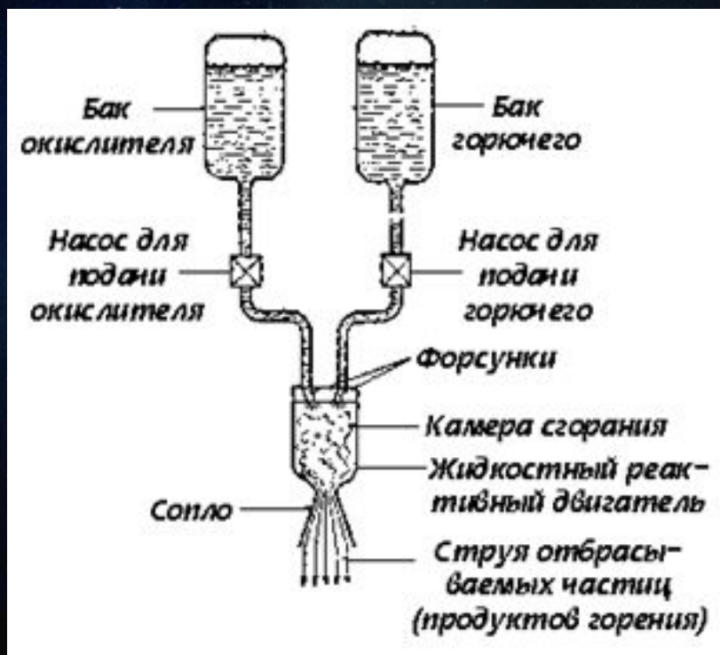
Простейшая схема жидкостного реактивного двигателя
