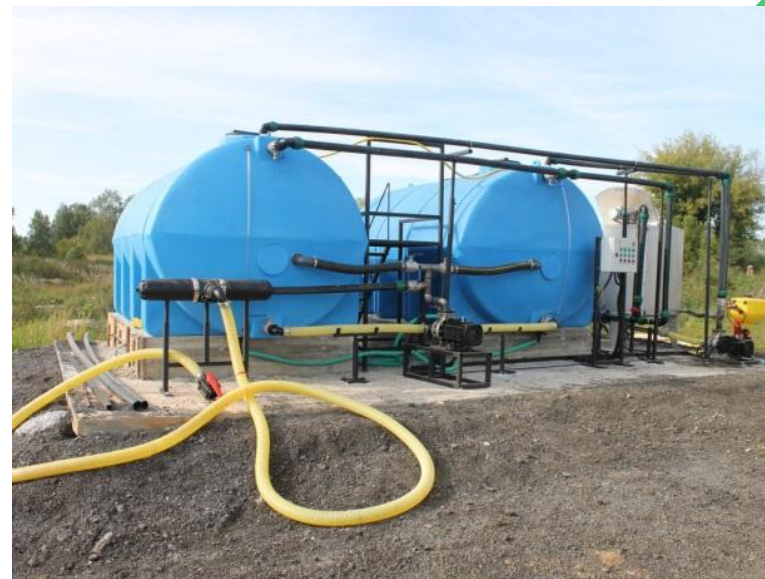
Стационарный растворный узел 23 м 3 с нержавеющей миксером пластиковыми емкостями 3,5 м 3 / 600л для СЗР и удобрений
