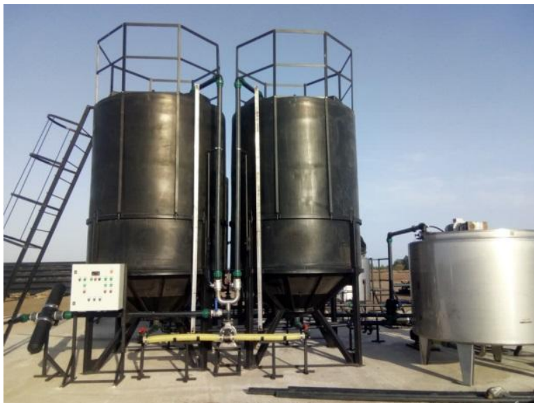
Стационарный растворный узел 23 м 3 с нержавеющей миксером пластиковыми емкостями 3,5 м 3 / 600л для СЗР и удобрений
