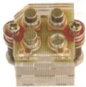
Рис. 3.7. Правильное расположение трех магнитов на датчике
