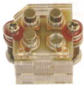
Рис. 3.7. Правильное расположение трех магнитов на датчике
