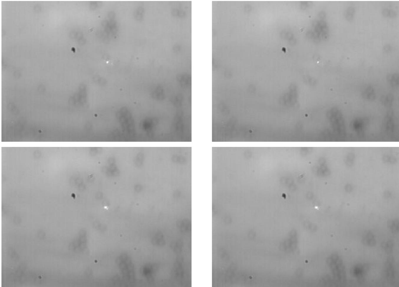
***Рисунок 6 – Перемещение полистироловых микрочастиц посредством взрыва центральной частицы при частоте кадров 1902 кадров/с***
