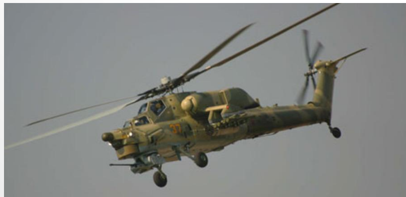
Ми-28Н «Ночной охотник» («Ростверстол») ударный боевой вертолёт для уничтожения танков, боевой техники и малоскоростных воздушных целей.
