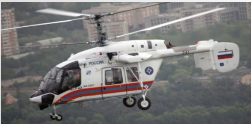
Ка-226Т (КумАПП) легкий многоцелевой вертолет для перевозки грузов и до 7 пассажиров.
