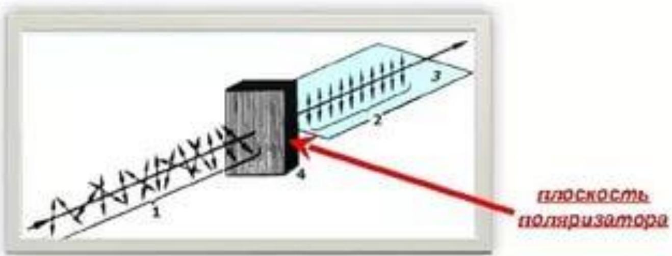
Поляризатор пропускает колебания, параллельные плоскости, которая называется **плоскостью поляризатора**, и полностью или частично задерживают колебания, перпендикулярные к этой плоскости.
