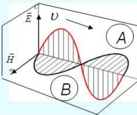
Плоскость, проходящую через луч и перпендикулярную направлению колебаний вектора  $\vec{E}$  (плоскость В), в которой колеблется вектор  $\vec{H}$ , называют **плоскостью колебаний**.
