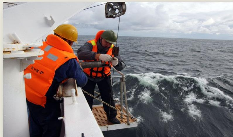
Процедура сбора информации про водные объекты — **это гидрографическая съёмка**. Данные, полученные в результате съёмки, преимущественно геореференцированы, т. е. привязаны к географическим координатам заданной степени точности, однако могут иметь и описательный характер.
