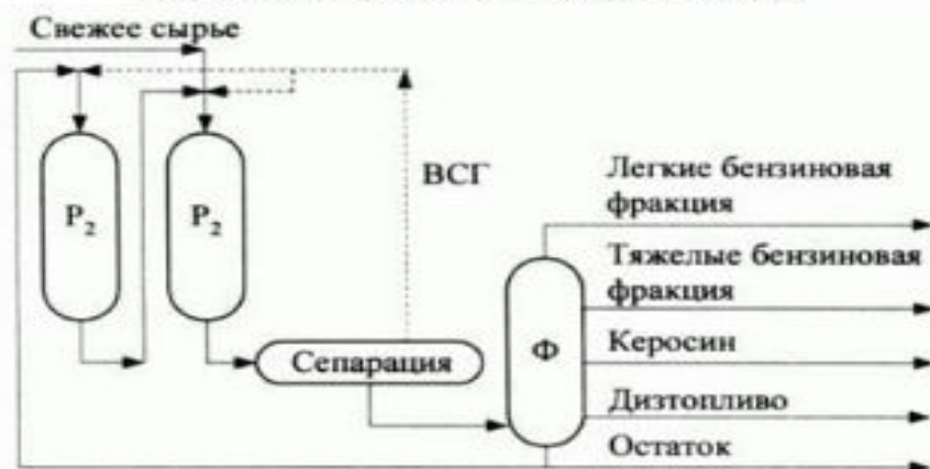
Рис. 8. Двухступенчатый процесс гидрокрекинга (Юникрекинг) с измененным движением потоков
