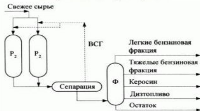
Рис. 7. Однопроходный процесс гидрокрекинга (Юникрекинг) с параллельными реакторами
