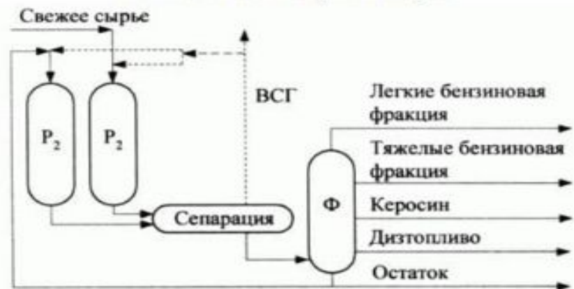
Рис. 6. Двухступенчатый процесс гидрокрекинга (Юникрекинг) с частичной конверсией сырья
