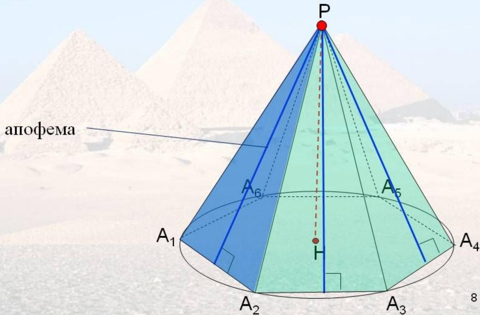
Площадь боковой поверхности правильной пирамиды равна половине произведения периметра основания на апофему.
