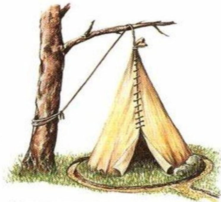
Водосток вокруг укрытия.
