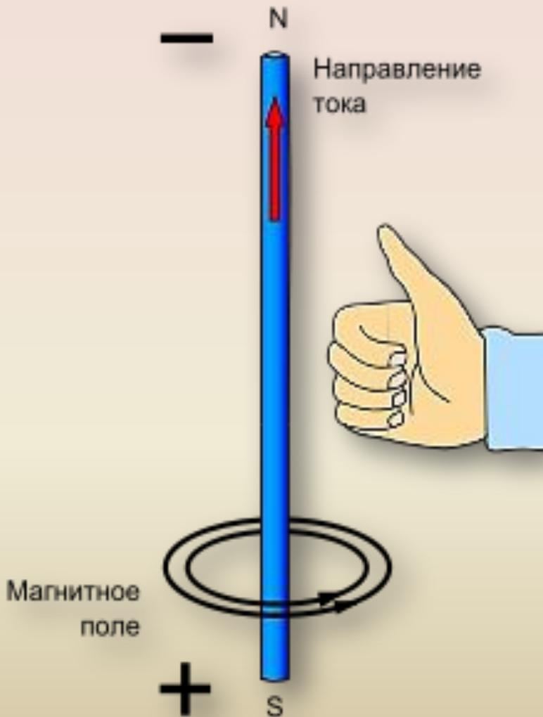
Если прямой проводник обхватить ладонью так, чтобы отогнутый большой палец указывал направление тока в проводнике, то оставшиеся пальцы укажут направление магнитных линий.
