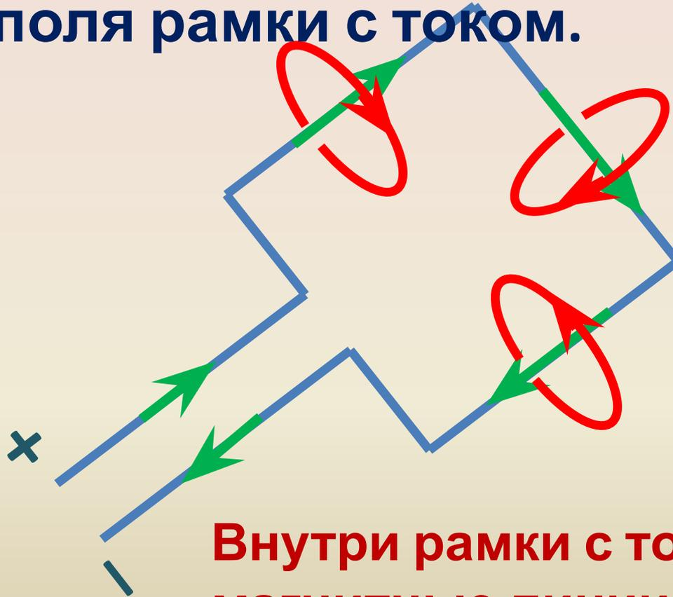
**Внутри рамки с током магнитные линии магнитного поля направлены «от нас».**
