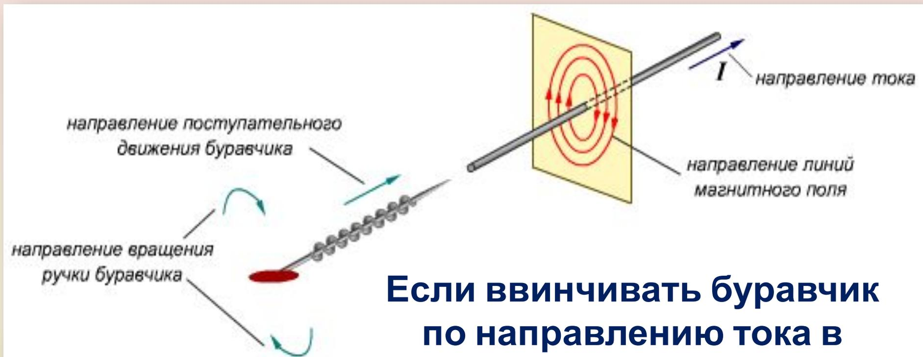
**Если ввинчивать буравчик по направлению тока в проводнике, то направление движения рукоятки буравчика укажет направление магнитной линии.**
