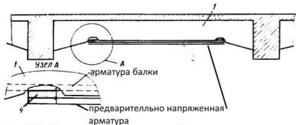
Усиление предварительно напряженной арматурой.
