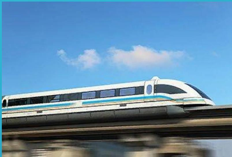
В днище вагонов поезда установлены сверхпроводящие электромагниты, охлаждаемые жидким гелием. При движении поезда в алюминиевых полосах-рельсах наводятся токи, в свою очередь создающие магнитные поля.
