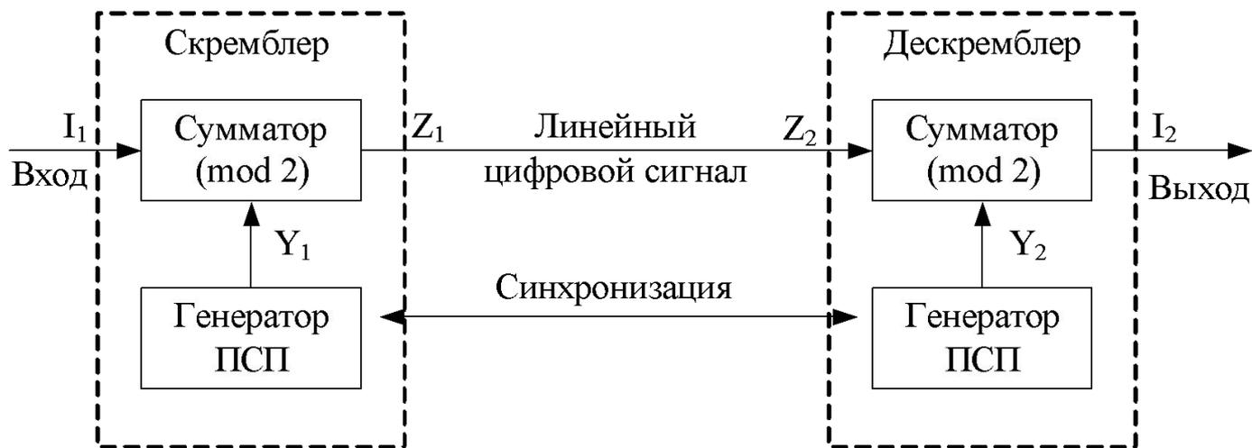
Исходными данными для разработки схемы скремблера является порождающий многочлен генератора ПСП (псевдослучайной последовательности), например вида:  $g(x)=1+x+x^9+x^{10}$ .
